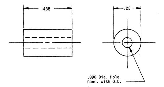
EXTENSION PIECE FOR CHERRY LOCK TOOL MODEL G55 - MAKE FROM 1/4 INCH MILD STEEL ROD
